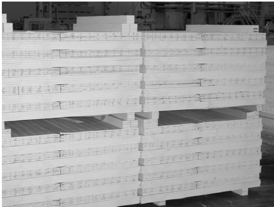
Figure 1 – Entretoises pour plaques de plâtre typiques
